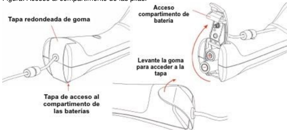
Figura: Acceso al compartimento de las pilas.
